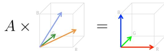
$$A \times \begin{bmatrix} tl_R & tr_R & bl_R \\ tl_G & tr_G & bl_G \\ tl_B & tr_B & bl_B \end{bmatrix} = \begin{bmatrix} 255 & 0 & 0 \\ 0 & 255 & 0 \\ 0 & 0 & 255 \end{bmatrix} \quad A = \frac{1}{255} \begin{bmatrix} tl_R & tr_R & bl_R \\ tl_G & tr_G & bl_G \\ tl_B & tr_B & bl_B \end{bmatrix}^{-1}$$
